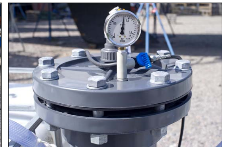
9. Polersteg, kolfilter med manometer
